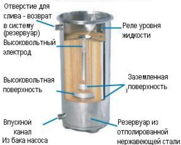
Резервуар Kleentek в разрезе
